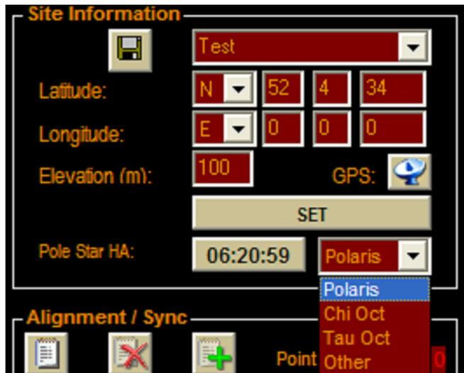
La posizione iniziale cannocchiale polare sarebbe allora con la stella nella posizione delle "ore 6:00". Quindi, se è stata selezionata Chi Octans, la posizione di partenza "6:00" per lo strumento di allineamento *polarscope* sarebbe:
